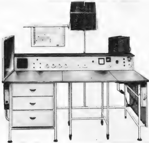
Ein für rationelles Arbeiten entwickelter Service-Arbeitstisch. Der Gerätewagen kann in den Tisch ein- und ausgefahren werden, schwere Fernsehempfänger braucht man nicht umherzutragen
